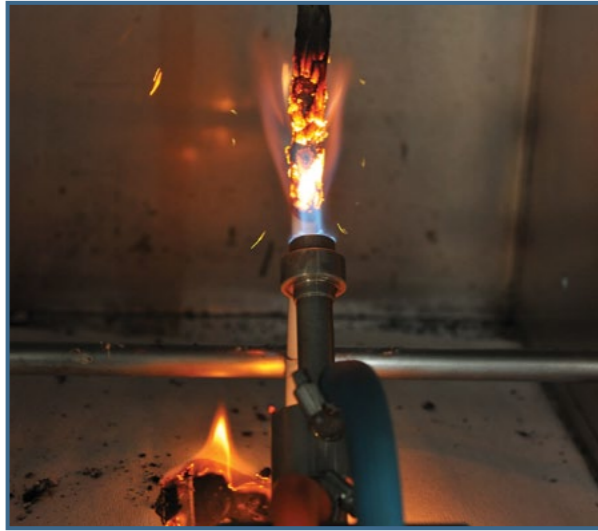
Yanan damlacık testindeki olumsuz bir kablo numunesi
