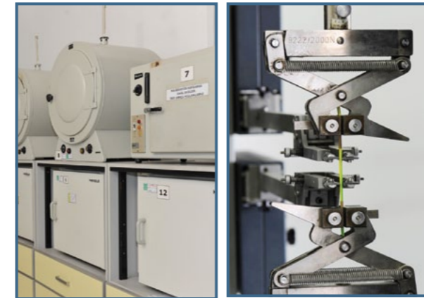
Yaşlandırma testleri için kullanılan fırınlar
