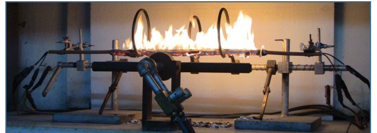
Gerilim altında yanma testindeki bir kablo numunesi
