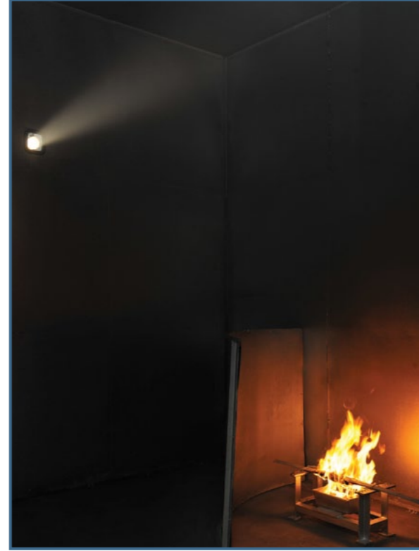
Duman yoğunluğu testindeki bir kablo numunesi
