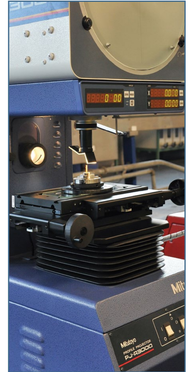
Profil projektör ile geometrik ölçümler yapılır.
