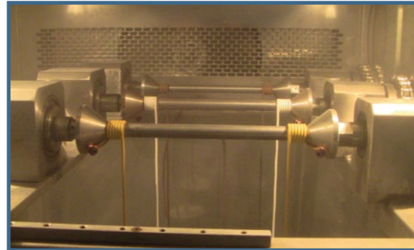
Döngüsel dayanım testindeki kablo numuneleri
