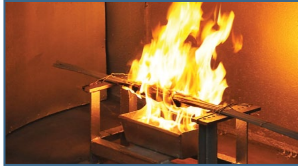
Duman yoğunluğu testinde, yakıt standartlardaki ölçülerde konulmalıdır.
