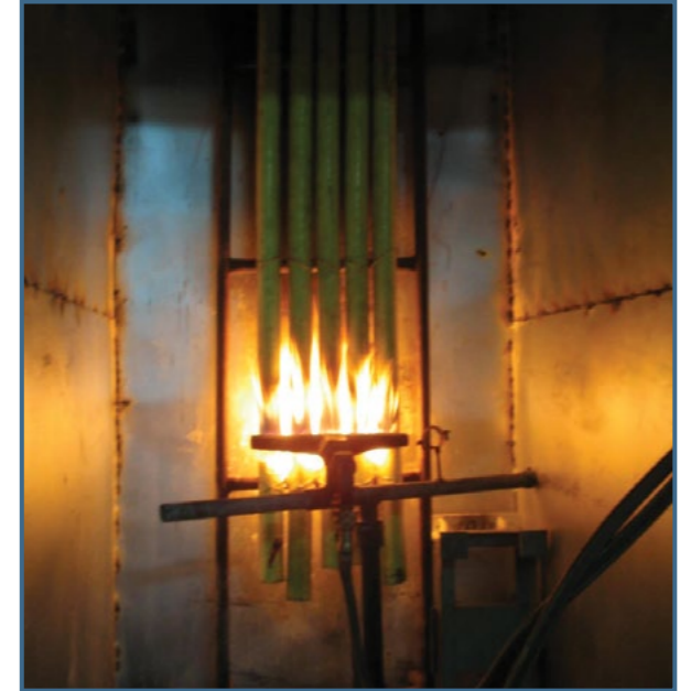
Demetlenmiş kabloların yanması testindeki bir kablo numunesi
