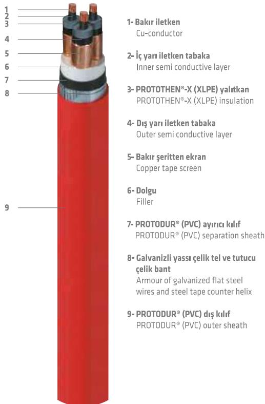
Üç damarlı, çok telli, bakır iletkenli, dielektrik kayıpları çok küçük PROTOHEN®-X (XLPE) yalıtkanlı, elektriksel alanı homojenleştirici özel iç ve dış yarı iletken tabakalı, yüksek kısa devre akımlarına karşı uygun kesitte ve özel olarak ilave edilmiş bakır ekrani, yassı galvanizli çelik tel zırhlı ve galvanizli çelik tutucu bantlı, PROTODUR® (PVC) dış kılıflı orta gerilim enerji kabloları.
